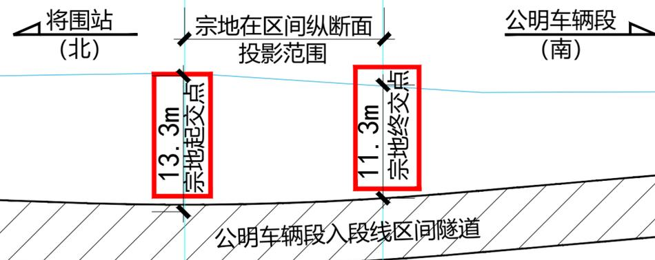
规划轨道交通13号线二期工程与A613-0093宗地相交关系纵断面图
