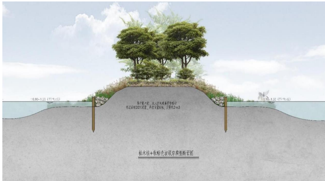
图 6.3 -2 松木桩+牡蛎壳驳岸示意图
