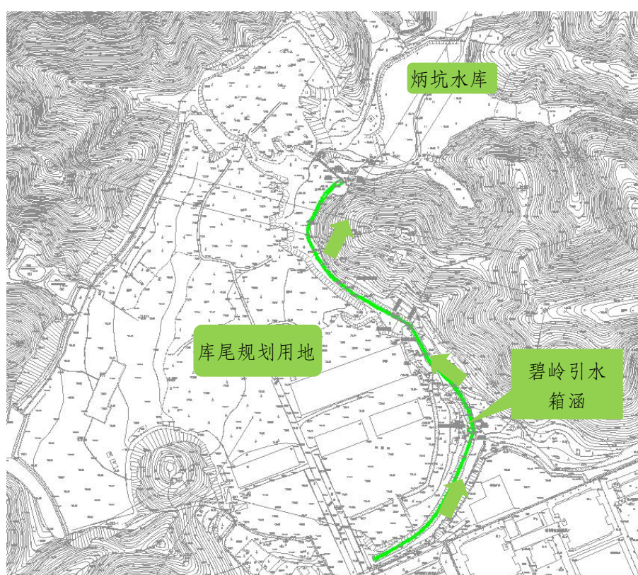
图 2.3-3 炳坑水库碧岭引水箱涵平面图
