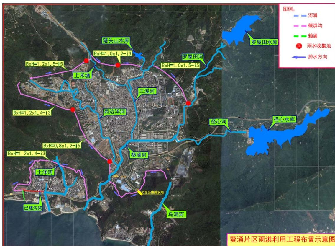
图 3.2-3 葵涌片区雨洪收集及利用工程布置
