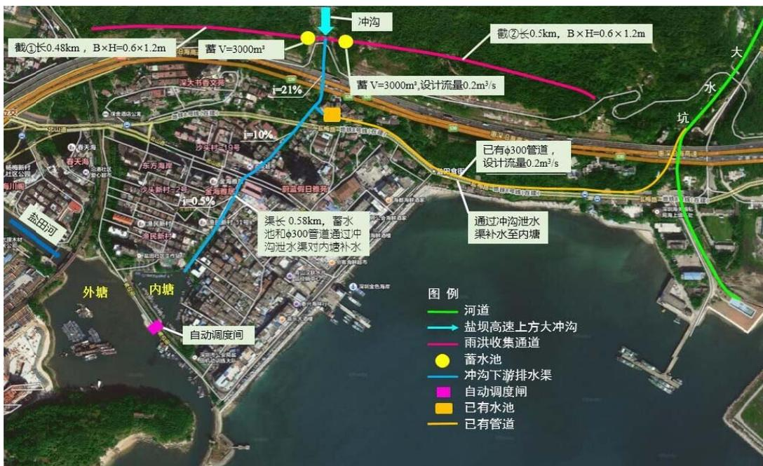
图 3.2-1 盐田河河口避风塘上游雨洪资源收集利用工程布置图
