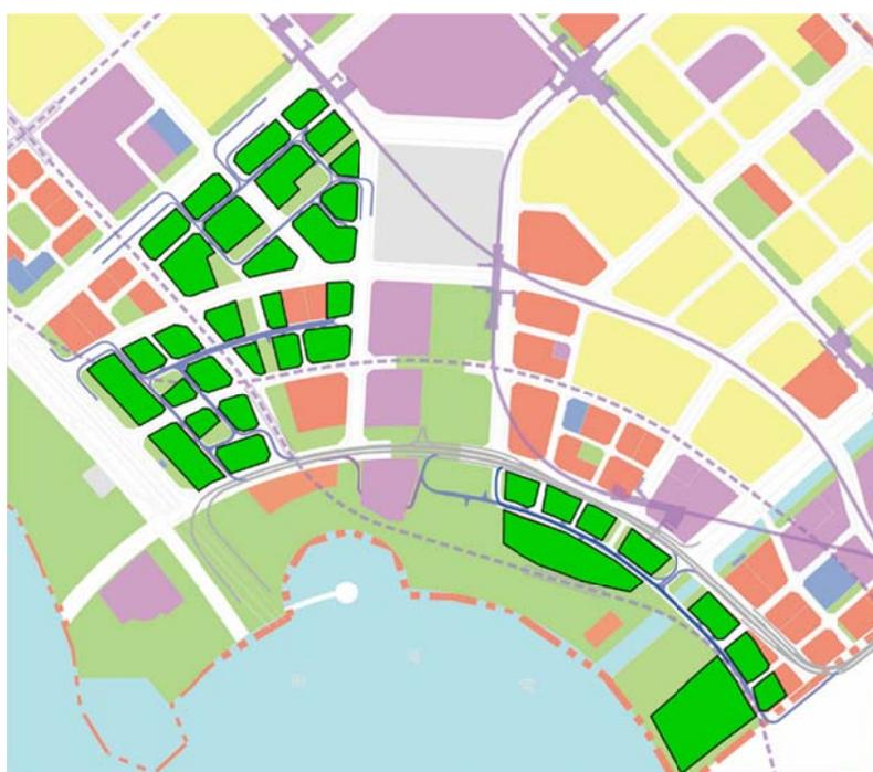
图 2-4 地下停车库布局示意图
