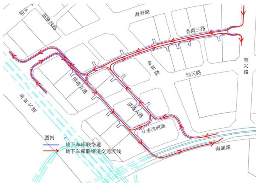
图 5-1 2 号地下车库联络道交通组织流线图
