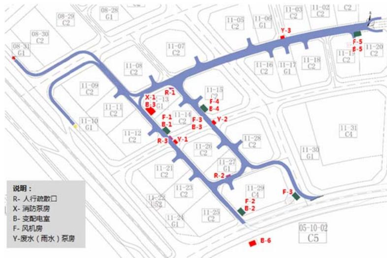
图 5-6 2 号地下车库联络道附属设施示意图
