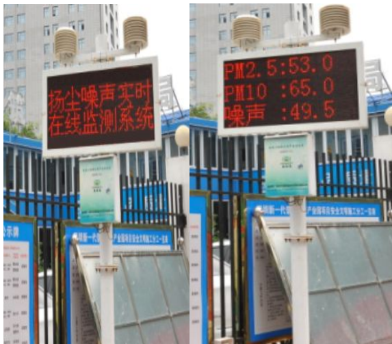
扬尘噪声实时在线监测系统实景图
