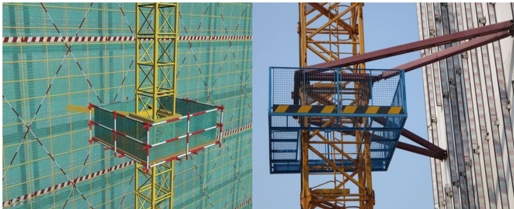
塔吊检修平台外观示意图
