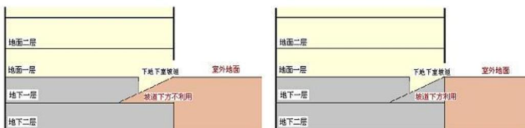
图29 下地下室车道图示
