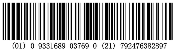
图B.4 基于全球贸易项目代码的单品追溯码一维码载体示例
