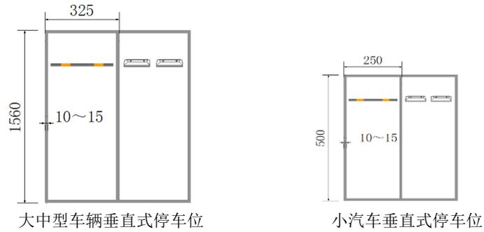
图 D.9 a) 垂直式停车位车位线 (单位: cm)
