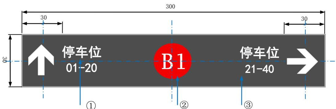
图B.12 停车位引导标志牌示意及推荐尺寸（单位：cm）
